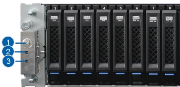
图 3-5 前面板挂耳指示灯（未安装前面板）
